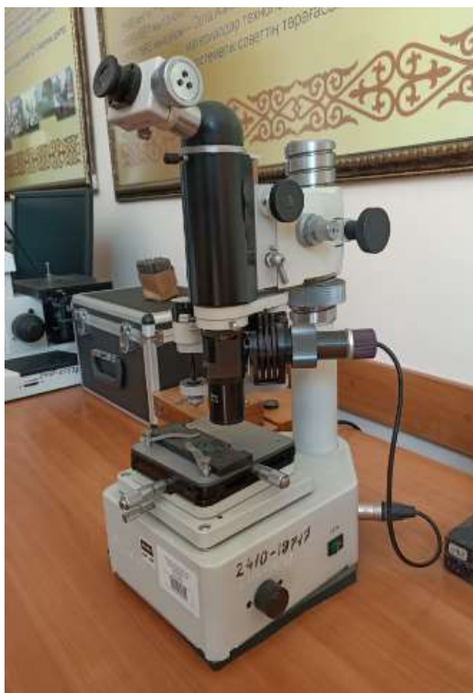
9 Сурет – Микроқаттылықты өлшеуші ПМТ-3М
